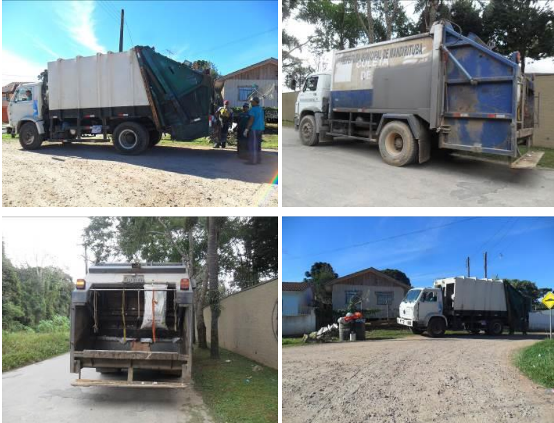
Figura 44: Caminhão compactadores que realiza a Coleta Convencional na Mandirituba.
