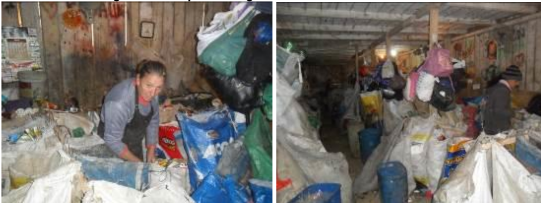
Figura 71: Etapa de triagem sendo executada em baias.
