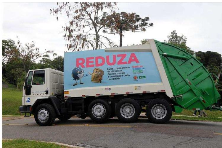
Figura 5: Caminhão compactador com 4º eixo
