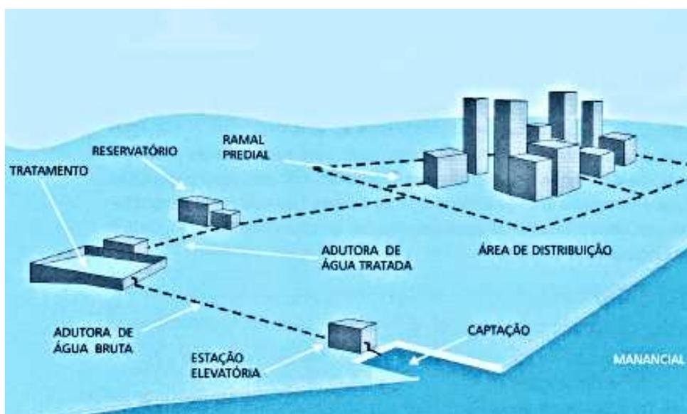
**Figura 1:** Esquema Geral de um Sistema de Abastecimento de Água
