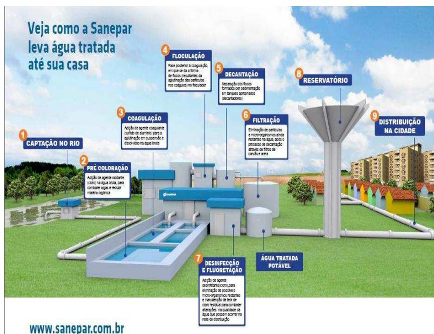
**Figura 7:** Representação esquemática do sistema de tratamento de água.
