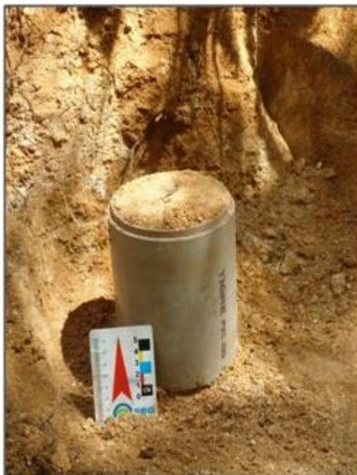
**Figura 39 - Ponto de coleta de amostra para análise do coeficiente de permeabilidade do terreno (PE-03).Fonte: Alexandra Vieira, 11/12/2012 (Acervo Andes).**
