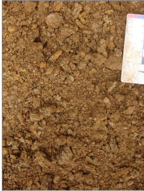
**Figura 40 - Argila-siltosa, de cor castanha alaranjado, por vezes cinza, com areia fina a argila com silte. Fonte: Alexandra Vieira, 14/11/2012 (Acervo Andes).**
