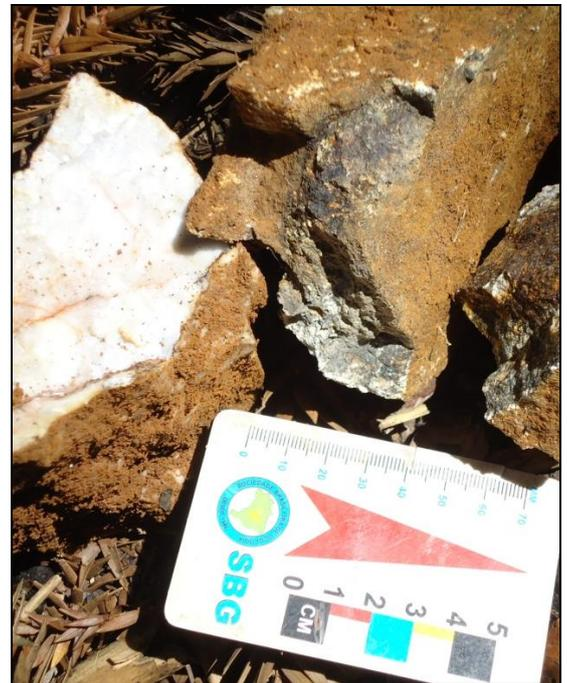
**Figura 43 - A esquerda: gnaissse levemente alterado. A direita: quartzo presente nos veios que cortam os gnaisses. Fonte: Alexandra Vieira, 11/12/2012 (Acervo Andes).**
