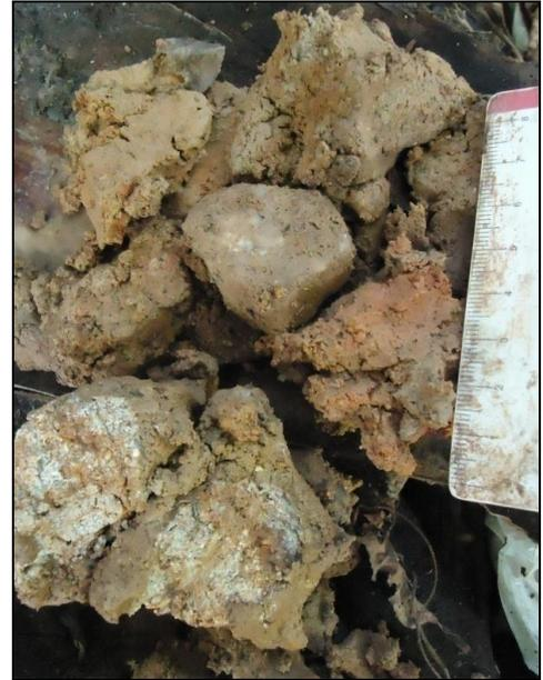
**Figura 41 - Argila-siltosa, de cor castanha alaranjado, por vezes cinza, com areia fina a argilosa com silte e com fragmentos centimétricos de rocha alterada mole. Fonte: Alexandra Vieira, 11/12/2012 (Acervo Andes).**
