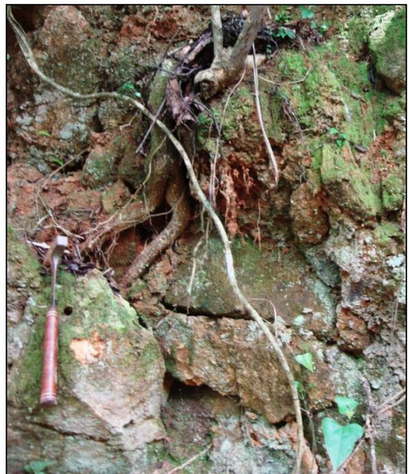
**Figura 50 - Afloramento AF-04. Blocos de gnaiss alterado em meio ao solo argiloso com areia fina a argila com silte, com estrutura da rocha pretérita (saprólito). Fonte: Alexandra Vieira, 01/10/2012 (Acervo Andes).**
