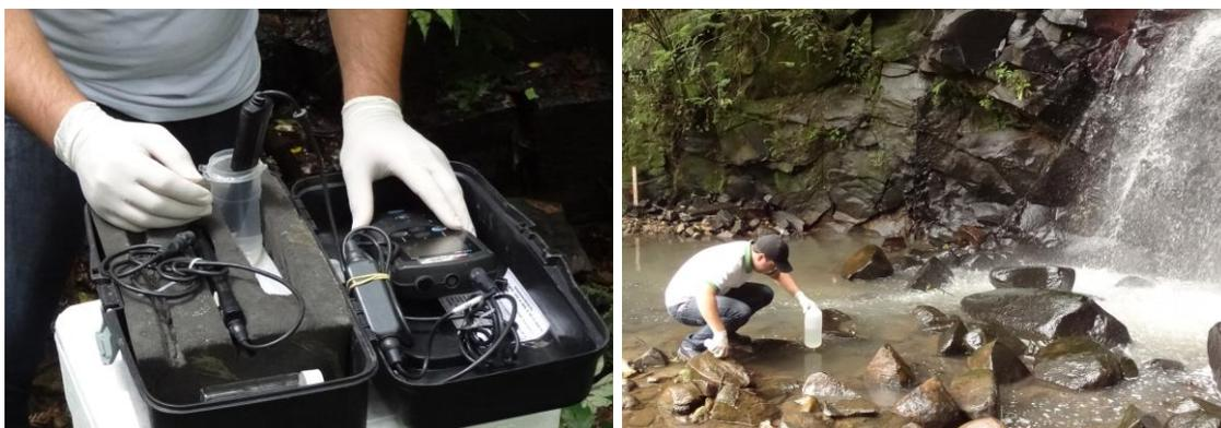
**Figura 32 - Equipamento para avaliação dos parâmetros em campo.**
