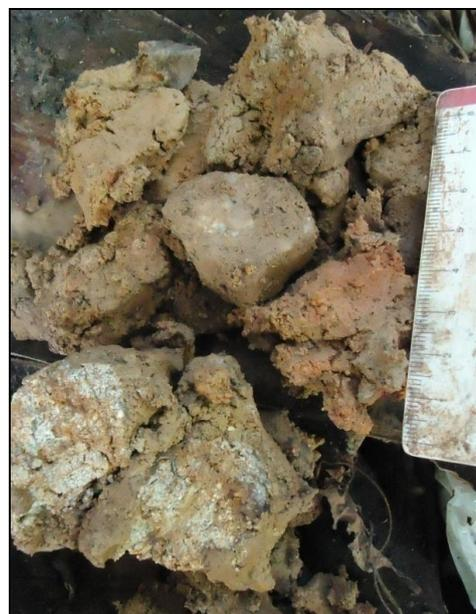
**Figura 41 - Argila-siltosa, de cor castanha alaranjado, por vezes cinza, com areia fina a argilosa com silte e com fragmentos centimétricos de rocha alterada mole. Fonte: Alexandra Vieira, 11/12/2012 (Acervo Andes).**
