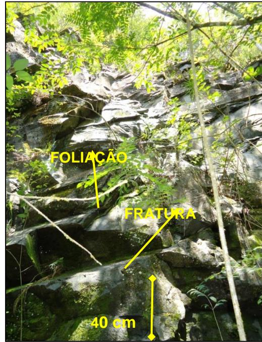
**Figura 47 - Afloramento AF-02. Parede de aproximadamente 12 metros de altura, gnaiss com fraturas espaçadas centimétricamente e porções foliadas. Fonte: Alexandra Vieira, 11/12/2012 (Acervo Andes).**
