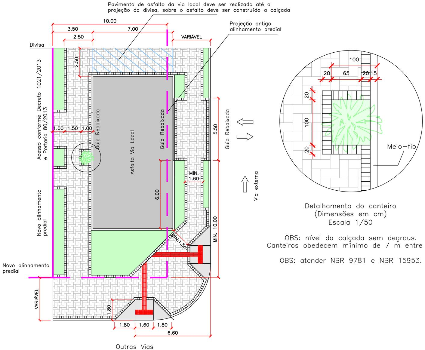
Detalhamento do canteiro (Dimensões em cm) Escala 1/50
