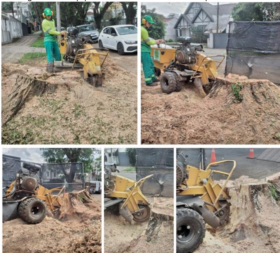
Figura 129 – Equipe destocando toco/raiz de uma tipuana removida
