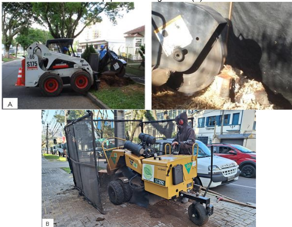
Figura 130 – Destocadores: equipamento desgastador acoplado em minicarregadeira (A); equipamento desgastador (B)
