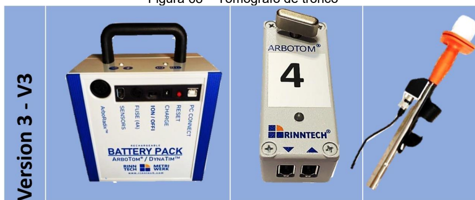
Figura 68 – Tomógrafo de tronco
