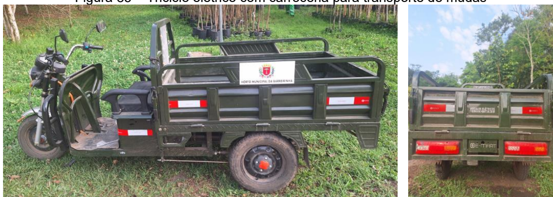
Figura 85 – Triciclo elétrico com carroceria para transporte de mudas
