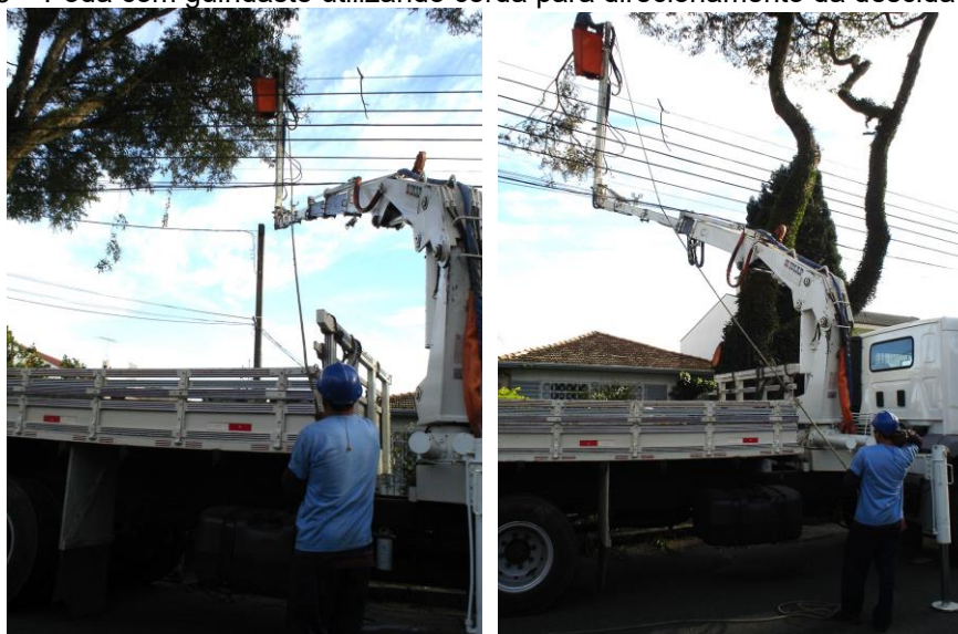
Figura 105 – Poda com guindaste utilizando corda para direcionamento da descida dos galhos
