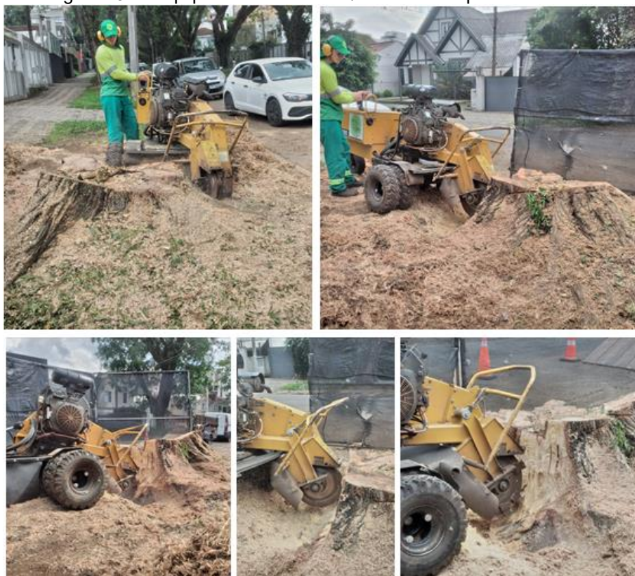
Figura 132 – Equipe destocando toco/raiz de uma tipuana removida
