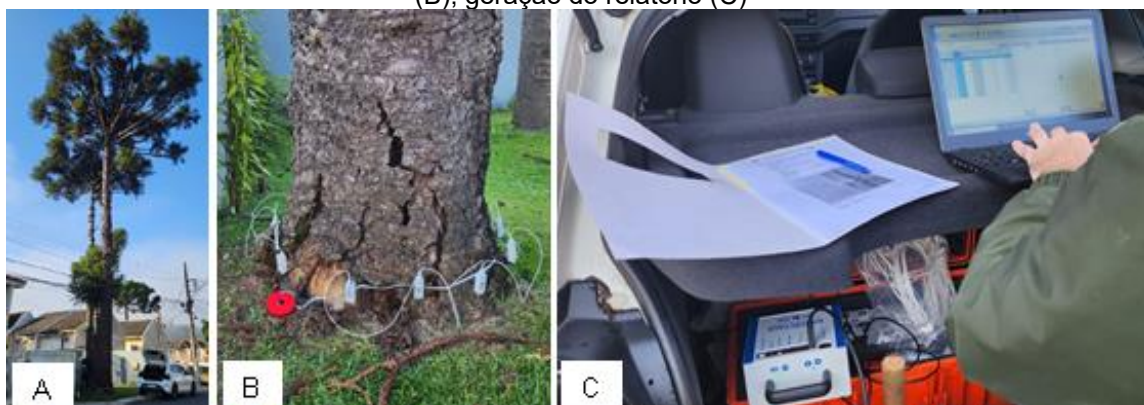
Figura 69 – Avaliação a campo: vista geral do indivíduo (A); detalhe dos sensores na base do tronco (B); geração do relatório (C)
