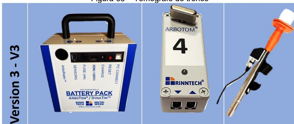
Figura 68 – Tomógrafo de tronco
