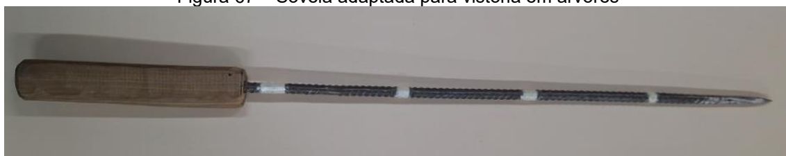
Figura 67 – Sovela adaptada para vistoria em árvores
